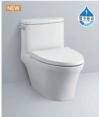
C-1704 ⊗ C880R 절수형 유아용 서양식 하이탱크 일체형 변기 (4ℓ, 1등급) 690 × 420 × 655mm (착좌높이: 340mm)
